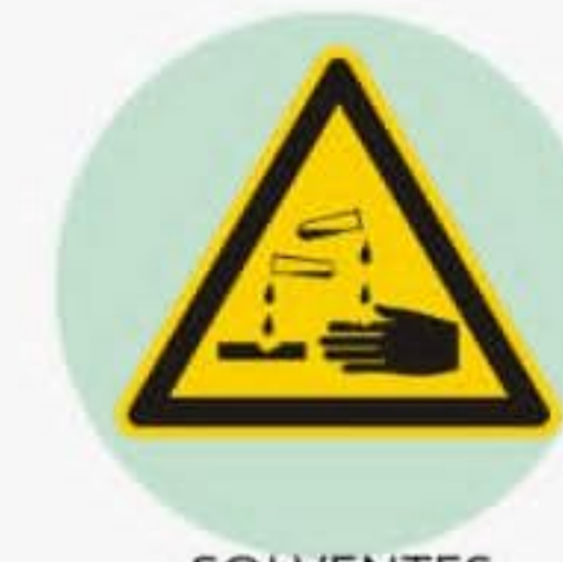
SOLVENTES Y CORROSIVOS
